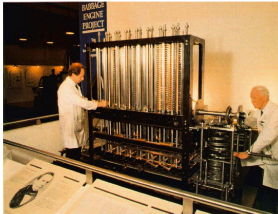
Figura 4: Máquina de Diferenças.
